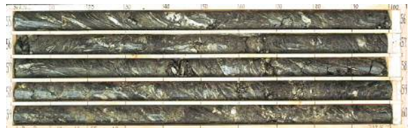
図-4 破碎帯の詳細な性状から地下水の遮水層としての機能を判断した。
